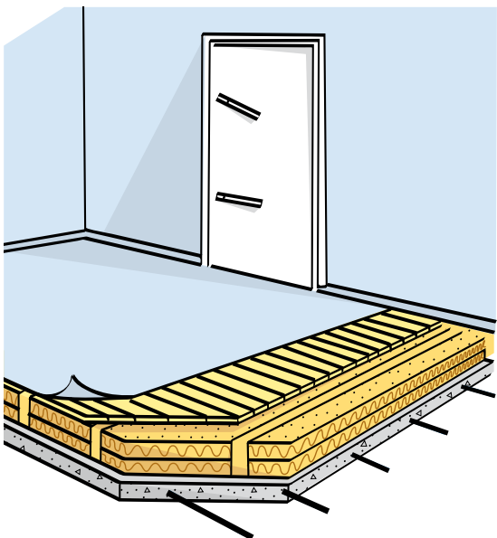
Eksempel på varmekabel i fryseromsgulv.
